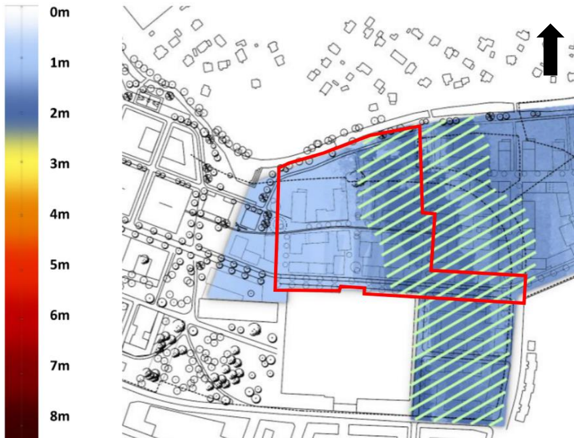
Figur 2-11. Uppskattad grundvattenytan under markytan där streckade området markerar fördelaktig zon att placera byggnader med källare. Bild hämtad ur Tyréns "Konceptuell utredning - CV-staden Örebro". Bild hämtad den 2023-04-06.
