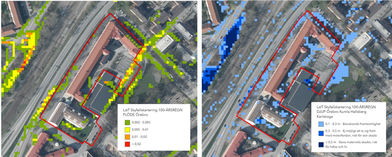
Figur 11. Till vänster: Maxflöde, angiven i m 3 /s/m vid ett 100-årsregn. Till höger: Maxdjup vid ett 100-årsregn, angivet i meter (Länsstyrelsen Örebro län, 2025).
