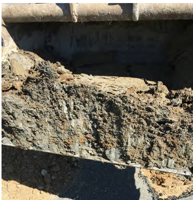
Figur 5.3. Torrskorpelera från 1,2-1,8 m djup på grävmaskinens skopa vid provgrop SM3.
