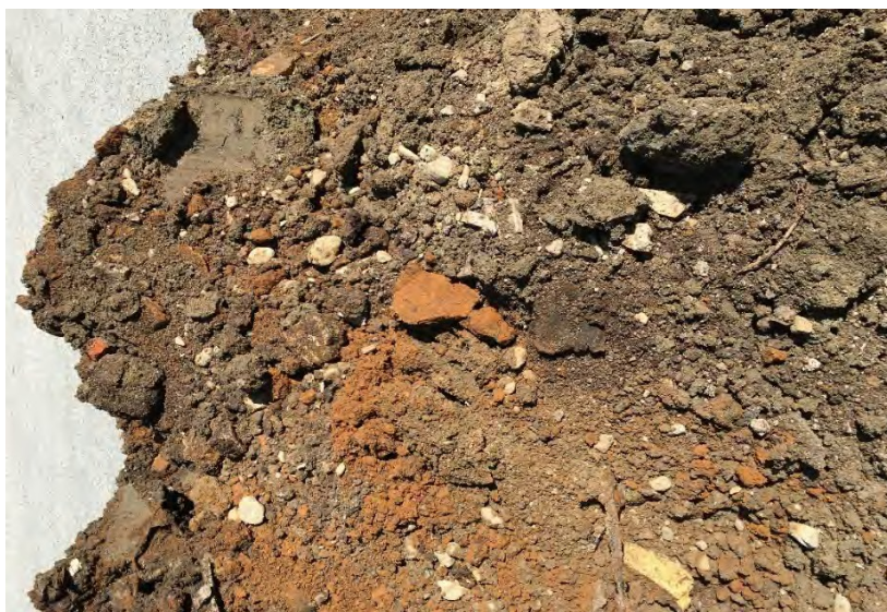
Figur 5.2. Fyllnadsmaterial från nivåerna 1,5 - 2m djup i provgrop SM4.
