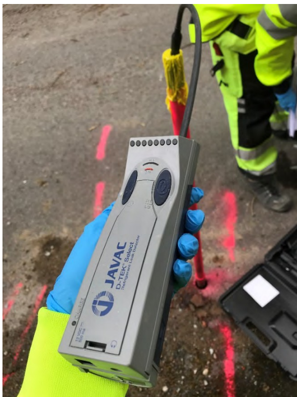
Figur 5.4. HDI mätning i grundvattenrör SM11.
