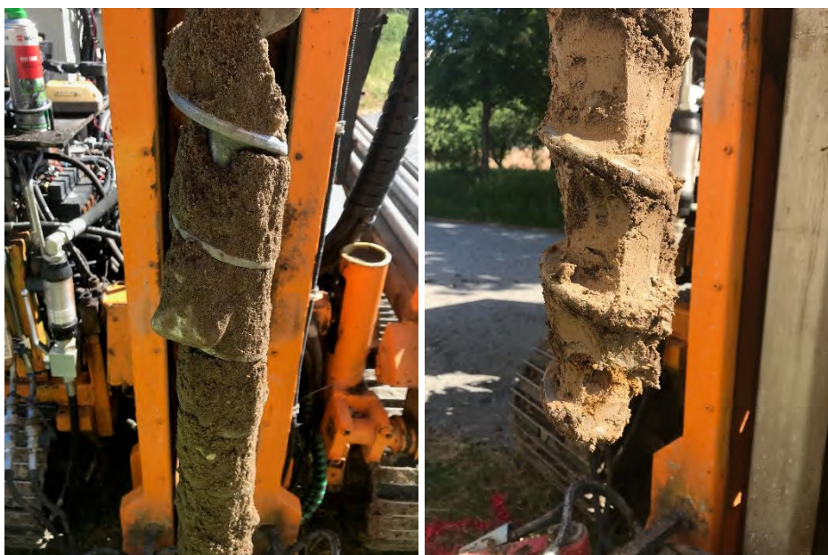
Figur 5.1. Till vänster den översta metern fyllnadsmaterial i skruvborrpunkt SM2. Till höger nivån 1,8-2m i samma skruvborrpunkt där materialet övergick till en sandigare silt. Möjligtvis isälvs-material.
