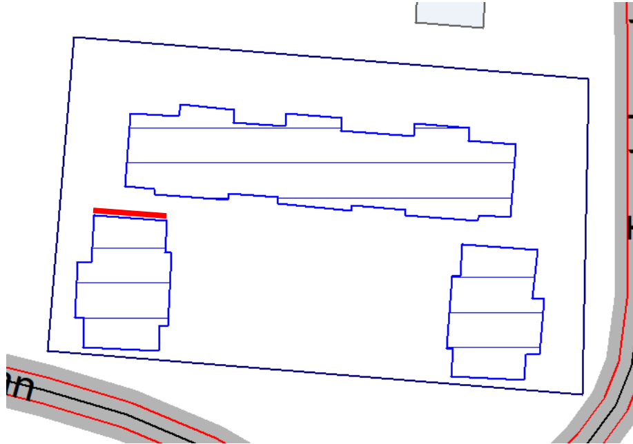
Figur 3. Rödmarkerad fasad kan utföras ljudabsorberande.
